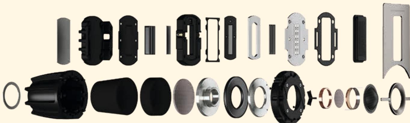
Der EVO-K-Tweeter vertraut auf einen 35 Millimeter Soft Dome Tweeter und einen Magnetostaten. Insgesamt kommt der Treiber somit in Höhen bis zu 34 Kilohertz
